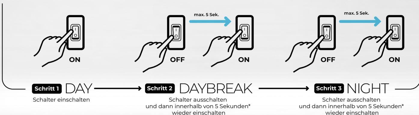
\* Wenn der Schalter nicht innerhalb von 5 Sekunden wieder eingeschaltet wird, wird die LED-Beleuchtung auf das Beleuchtungsmodus DAY eingestellt
